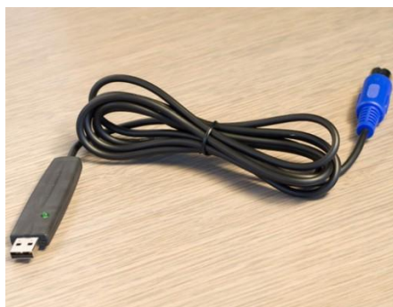
Abbildung 2: ACS-CB-USBPROG Programmierkabel und Systemkonfiguration in Schritt 4
