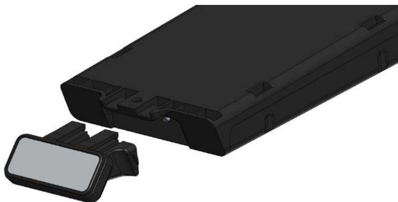
Abbildung 5: Montage anclipbarer Handschalter
