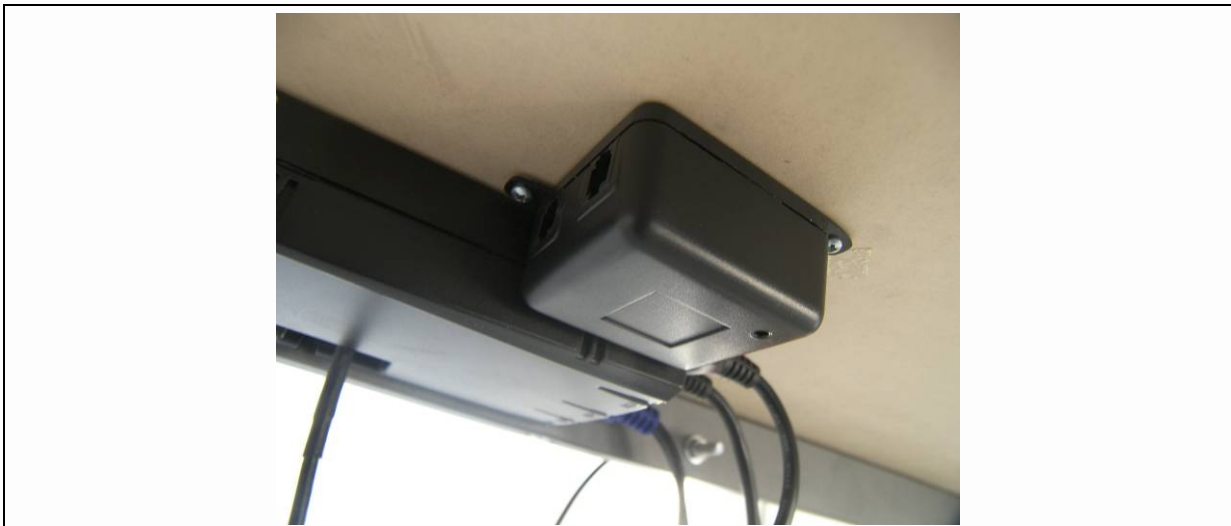
Abbildung 5: ACS-CB-SENS in der Nähe der Motorsteuerung montiert
