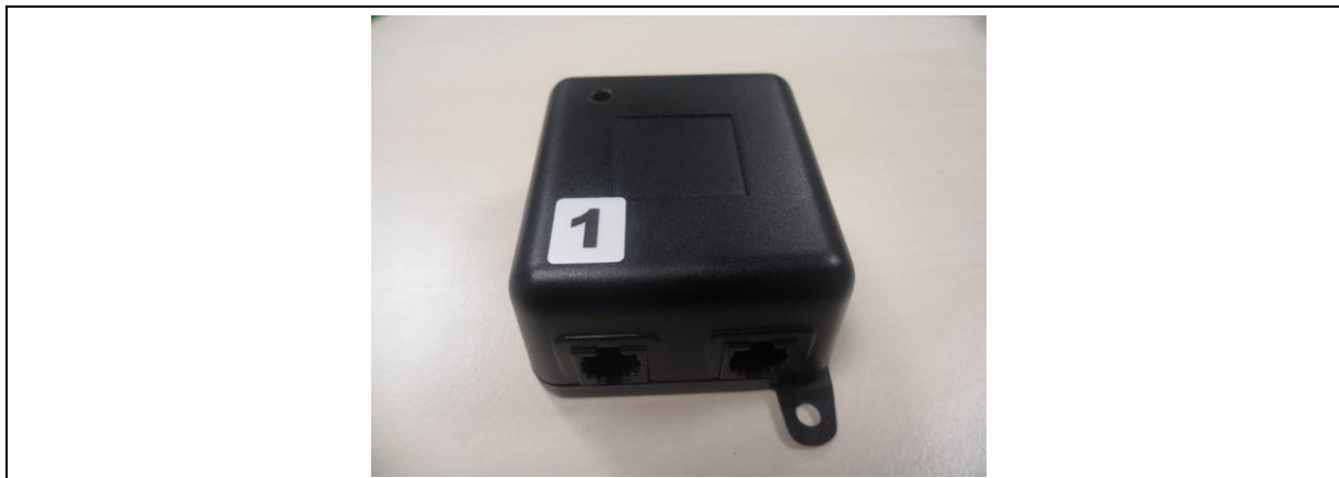
Abbildung 8: RJ-Buchsen und Markierung der Buchse 1
